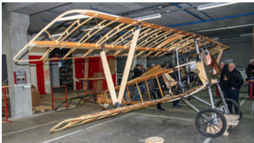
Mit dem Zusammenbau von Rumpf, Flügel und Fahrwerk der ersten Nieuport 23 C-1 wurde ein wichtiger Meilenstein erreicht.
