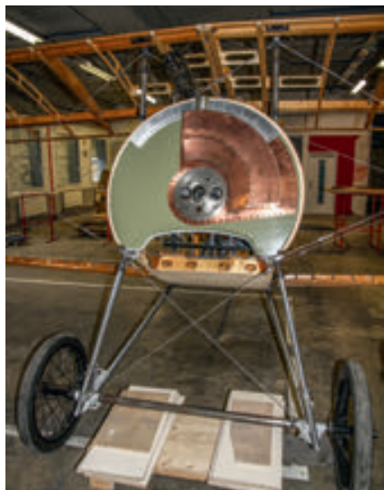
Auf der Brandschottwand (links) ist der Kupfertank für das Rizinus-Schmieröl montiert. – Jetzt noch gut sichtbar sind die beiden Tanks für das Rizinusöl und das Methanol als Treibstoff.
